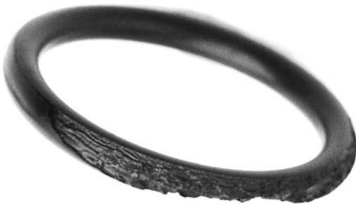
Bild 9.6 Extrudierter O-Ring
