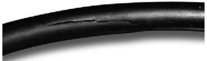
Bild 9.12 Oberflächenzerstörung durch explosive Dekompression
