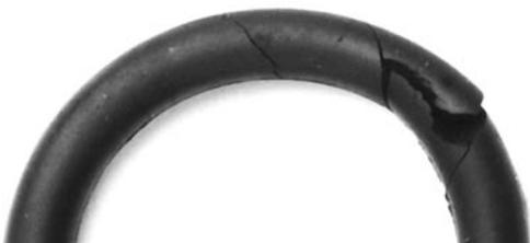
Bild 9.11 Verdrehter O-Ring mit Einschnitten in der O-Ring-Oberfläche
