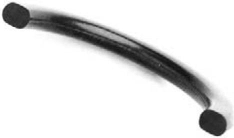
Bild 9.9 Schadensbild durch hohe bleibende Verformung (Compression Set)
