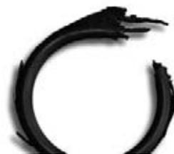
Bild 9.6 Extrudierter O-Ring
