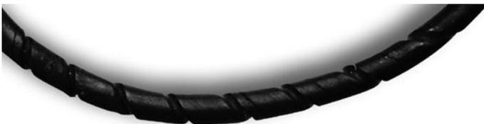
Bild 9.10 Verdrehter O-Ring mit spiralförmigen Markierungen
